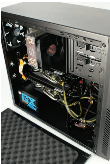
Jó kábelelrendezéssel még egy ennyire zsúfolt gép is egészen rendezettnek tud tűnni
