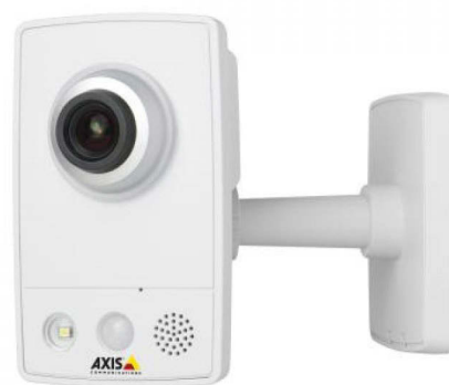
Axis M1034-W: kétirányú hanggal, LED-lámpával és infra-mozgásérzékelővel
