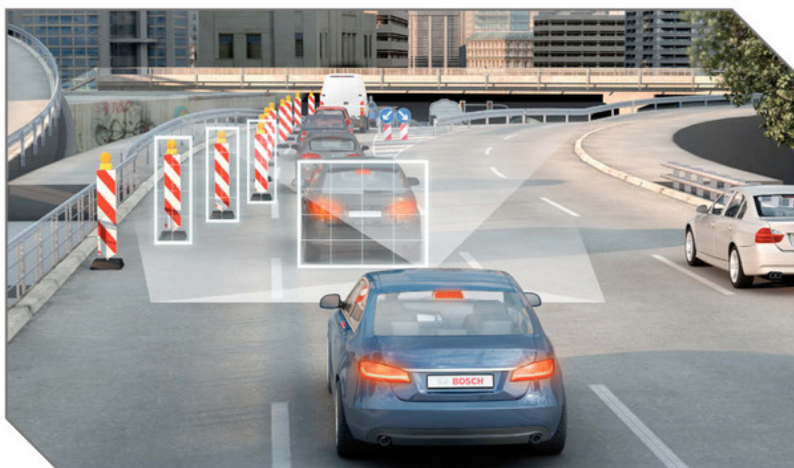
Aktív tempomat: úgy követhetünk egy előttünk haladó járművet, hogy az autó annak sebességéhez igazodik a megadott maximum értékig; ha kell, önmaga kanyarodik
