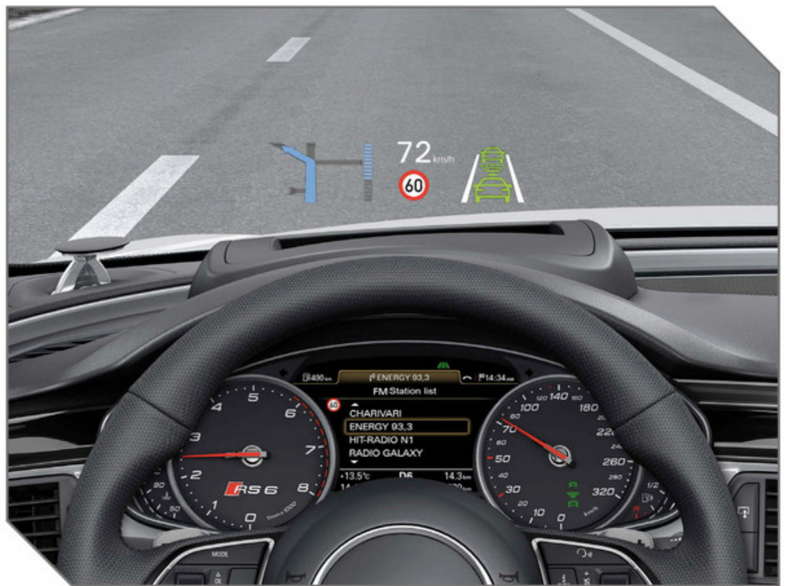
HUD: kiterjesztett valóság a szélvédőn, minden fontos információval
