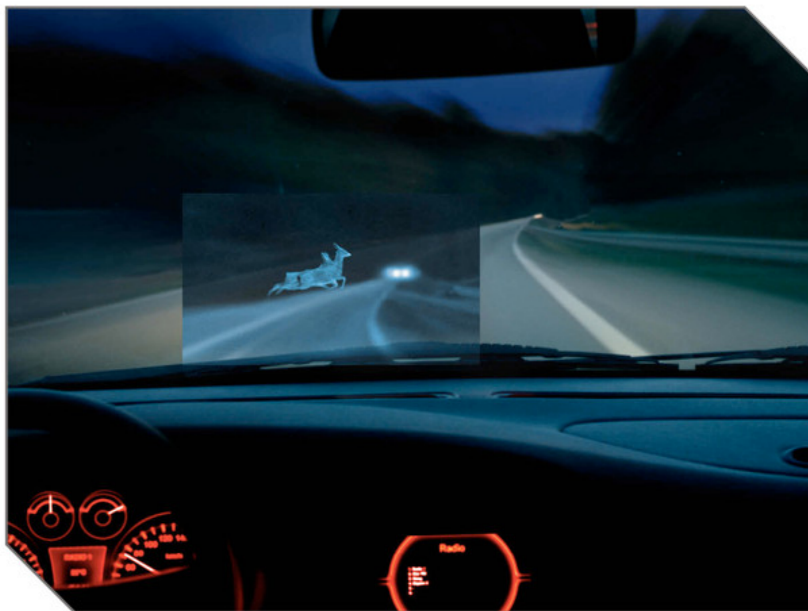
Éjjellátó: a kamerák érzékelik az úton áthaladó élőlényeket, és jeleznek, cselekednek
