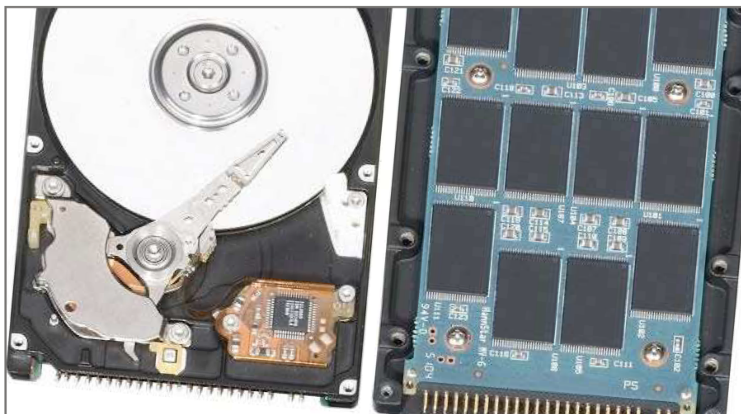
HDD vs. SSD: utóbbi könnyebb, gyorsabb, kevesebbet fogyaszt és már olcsó is
