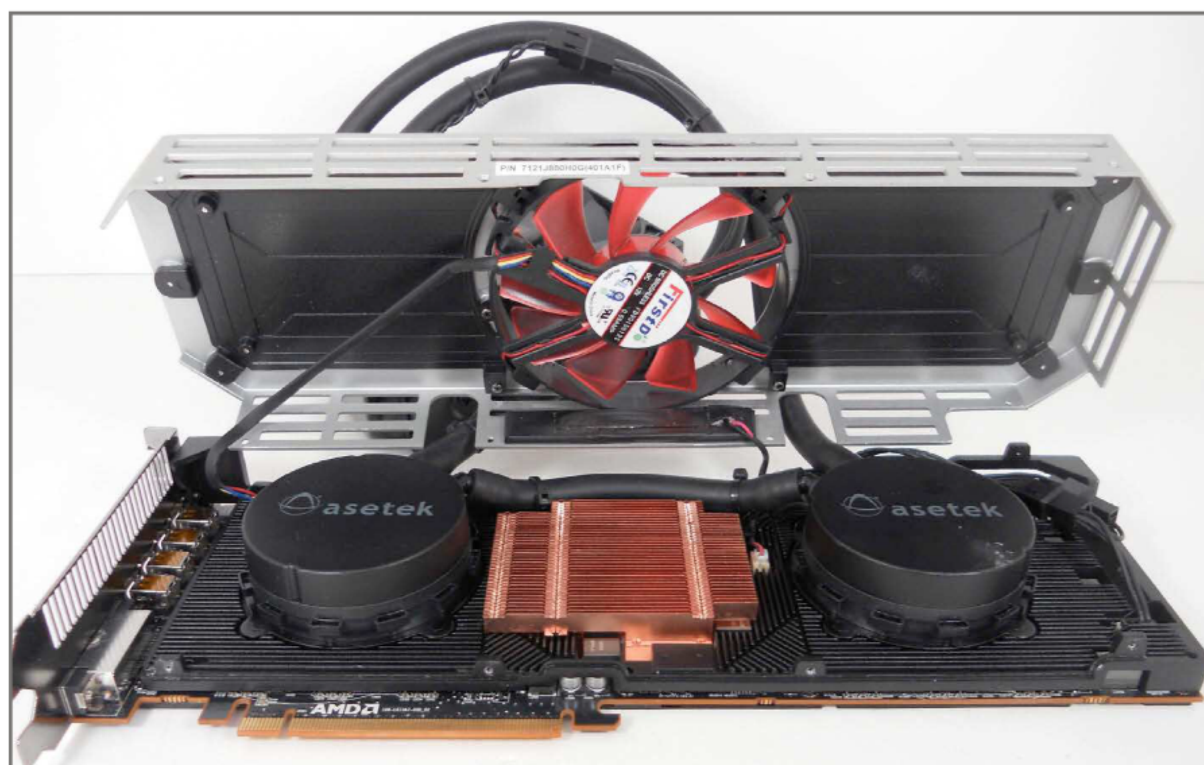
Boncasztalon a Radeon R9 295X2: dupla GPU, dupla hűtőblokk és természetesen dupla zajszint
