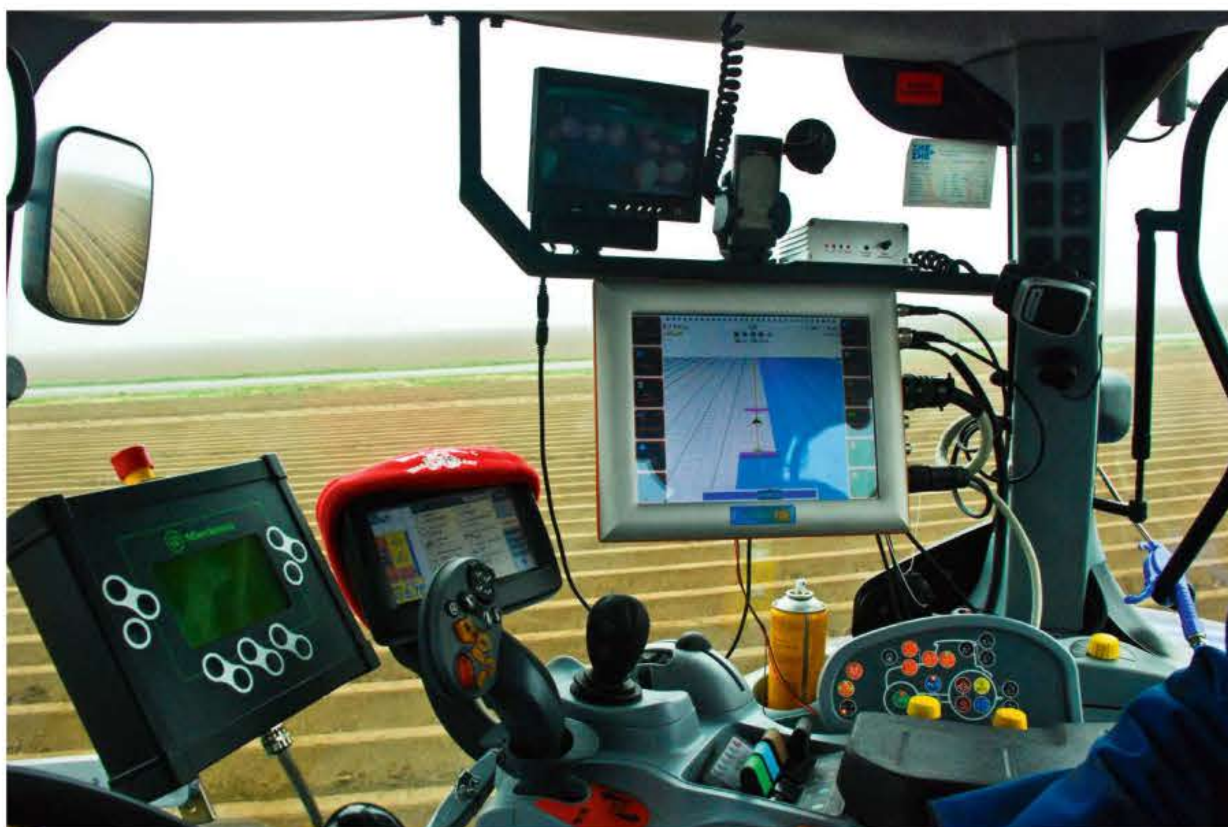
Pilótafülke: a gazdák a kültéri munkák során folyamatosan figyelemmel követhetik az elvégzett feladatokat és a talaj változásait a traktorba szerelt monitorok segítségével
