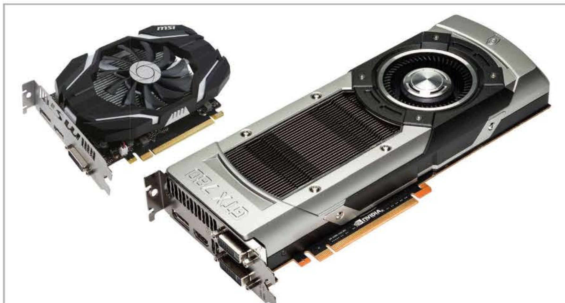
GeForce GTX 780 vs. GeForce GTX 1050 Ti: fele akkora méret és fogyasztás, azonos 3D-teljesítmény
