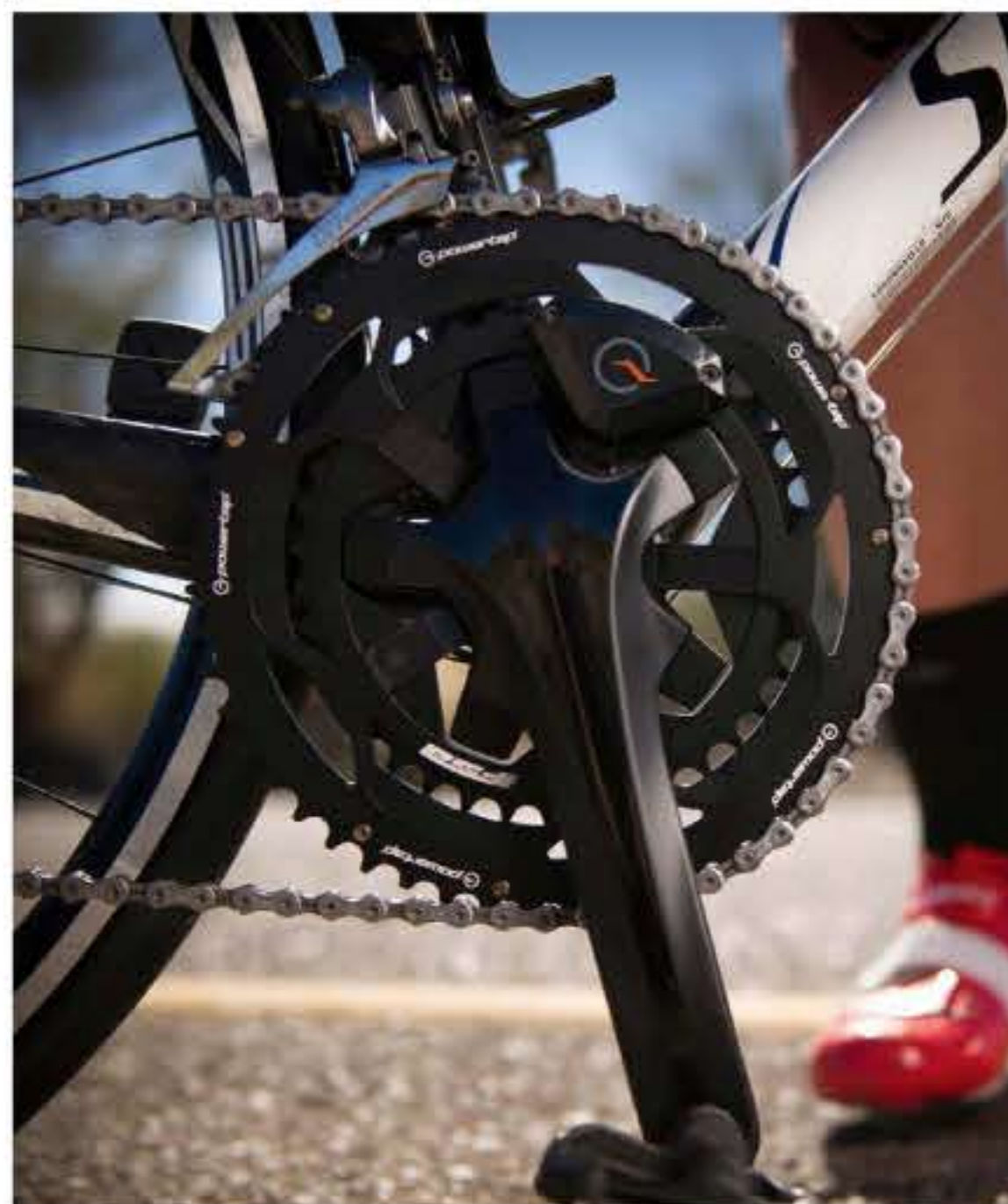
Pedálméter: a kerékpárosok egyik legfontosabb eszköze a pedálba épített teljesítménymérő
