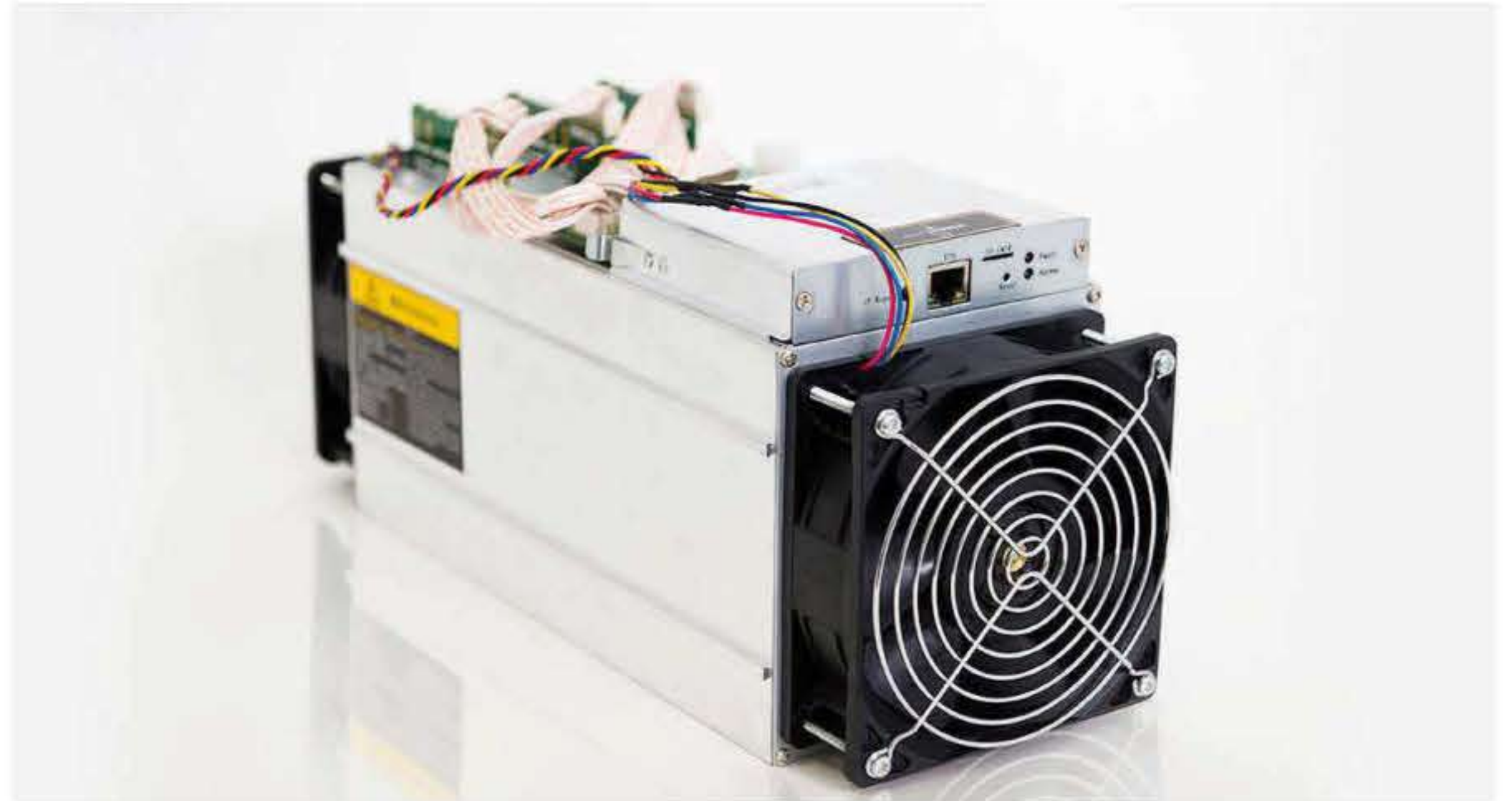
Magabiztos bányászgép otthonra: az Antminer S9 a benne lévő 16 nanométeres ASIC chip révén még most is alkalmas magányos bányászatra
