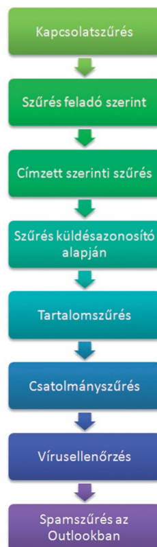
1. ábra. A spam- és vírusszűrés egymásra épülő rendszere az Exchange 2007 rendszerben
