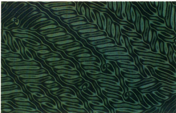
Az LCD-kben használt folyadék-kristályok általában hosszú molekulákból állnak.
