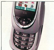
Szétcsúszás. Rendhagyó módon, a kijelző alól csúsztatható ki az SL 55-ös billentyűzet.
