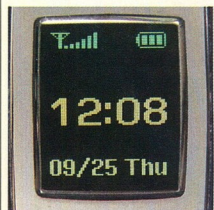
Külső kijelző. Az E700-as második számú kijelzője OLED technológiával készült, és a kamera keresőjeként is alkalmazható.
