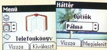
Kijelző. Az X3-2 kijelző csupán 101x80 pixel felbontású, viszont 4096 színt jelenít meg.
