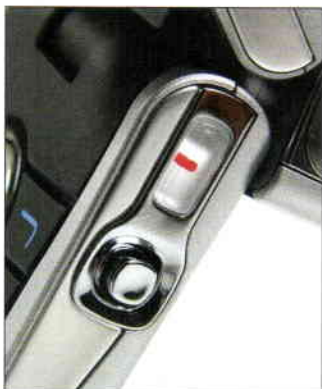
A készülék élén elhelyezett exponáló és navi gombok jól kézre esnek. A navi gombbal zoomolhatunk és böngészhetünk a kamera menüben.
