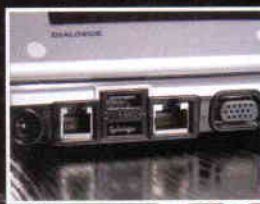
USB, LAN, külső display, töltő és modem.
