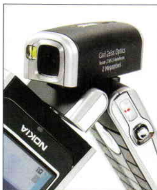
A kamera a készülék alsó és felső részétől függetlenül 180 fokban elforgatható, így szinte bármilyen pozícióban tudunk fotózni.
