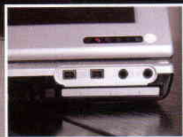
Firewire, füles, mikrofon és PCMCIA-nyílás.
