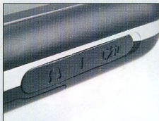
A fémcsalódalsíkba süllyesztve találjuk a portokat, amelyeket gumidugasz véd.
