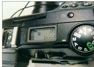
Fellelhetőleg az analóg száziáróbi öröklődött ez a másodlagos kijelző, amelyen a legfontosabb paramétereket mindig megtaláljuk.
