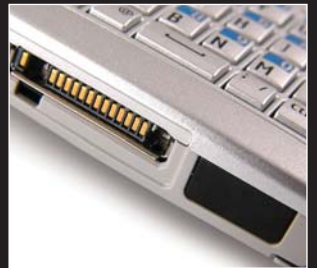
Az E61-es töltőcsatlakozója az újabb modellekben feltűnt vékony verzió. A pop-port mellett helyezték el az infraportot.
