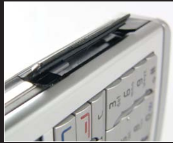
Az E60-as beépített memóriája RS-MMC-kártyával bővíthető. A kártyafoglatat szinte észrevétlenül bújjuk meg a fényes díszcsík mögött.
