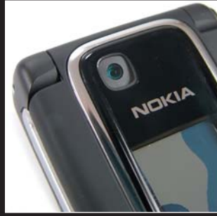
1,3 megapixeles fixfokuszos kamera lapul a külső kijelző felett szerényen meghúzódva. Elhelyezkedéséből adó- dón sosem fog belelőgni az ujjunk a képekbe, azonban a fotófény hiánya miatt éjszaka ne is próbálkozzunk.
