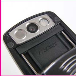
A kamera elhelyezése csak némileg módosult a D600-aséhoz képest. Elsőként a jellege változott (süllyesztett), másodsorban a felbontása is kisebb.
