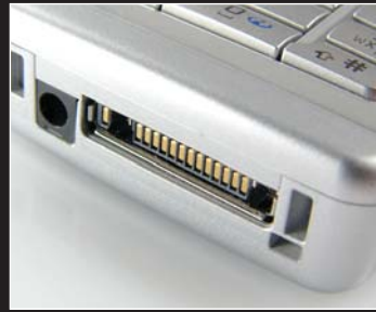
A készülék alján, a csatlakozósor mellett a hagyományos Nokia töltőaljzat található, így a régebbi Nokia modellek töltője is használható az E60-assal.
