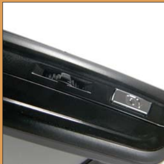
Ide került a kamera exponáló gombja, valamint egy jog-dial jellegű kezelőszerv. Ez utóbbival állítható a hangerő, illetve fényképezőgép-üzemmódban ennek segítségével zoomolhatunk.
