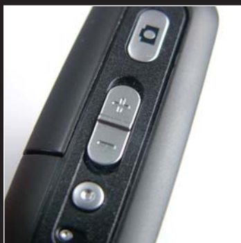
Külön gombot kapott a beépített fényképezőgép. Megnyomása után aktivizálódik a kamera, és exponálni is ezzel lehet.
