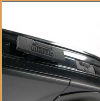
A tetemes belső memória miniSD-kártyával bővíthető, így a tárcapacitását nem jelenthet problémát. A kártyanyílást a készülék oldalán helyezték el.
