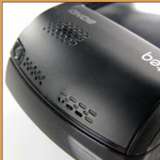
A bekapcsoló gomb mellett helyezték el a vezeték nélküli funkciókról, illetve a bejövő üzenetekről értesítő LED-et, valamint a két hangszórós, térhatású hangrendszer egyik zajkeltőjét.
