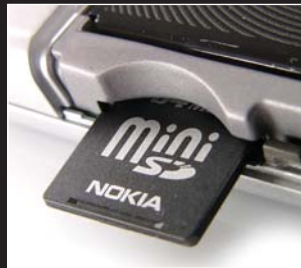
MiniSD-memóriakártyával bővíthető az E61-es készülék. A kártya eltávolításához, illetve behelyezéséhez le kell venni a hátlapot.
