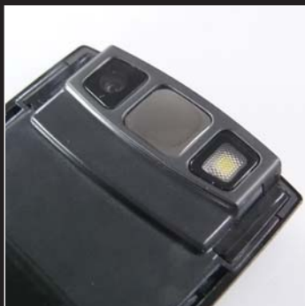
A Samsungnál nem elégedtek meg az 1,3 megapixeles felbontással, 2 megapixeles kamera került a készülékbe.
