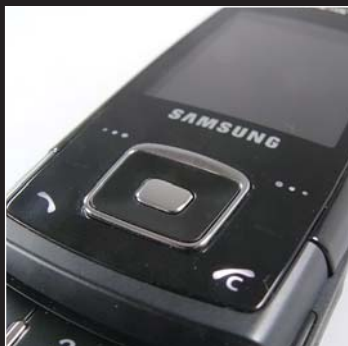
A Samsung E900 esetében a koreai mérnökök az LG Csokihoz hasonlóan érintőgombokat alkalmaztak, de a navigógomb a hagyományos "nyomós" kivitel.
