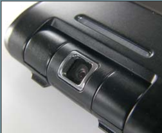
Ritkán alkalmazott praktikus megoldás a körbeforgatható kameramodul. Furcsa lenne Mikrobi és R2D2 sikerét is ebben a megoldásban keresni, de hátha.
