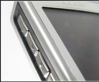
Az E60-as bal oldalán, a hangerőállító gombok mellett találjuk a hangrögzítő indítógombját. A hangfelvétel telefonbeszélgetés közben is működik.
