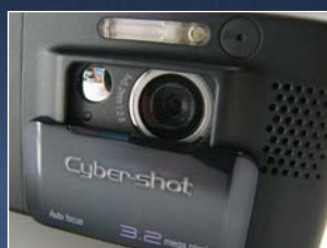
Az elhúzható fedlap alatt rejtőzik az optika. A K800i készülékben xenon vaku és AF segédfény is van, akár csak a "valódi" fényképezőgépekben.
