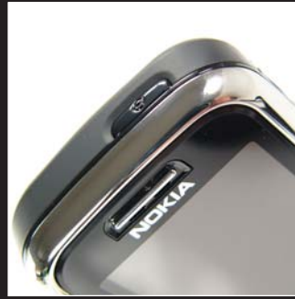
A fenti hosszúkás gombbal nemcsak ki/be kapcsolni lehet a telefont, hanem profilt váltani is itt tudunk, és a rádiós elemeket kikapcsoló repülőgépes üzemmód is itt aktiválható.
