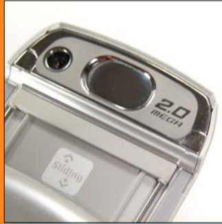
A készülék slide-mechanikája remekre sikerült, és a megvalósításnak hála tartarja a kamerát és a hozzá tartozó tükröcskét, ezzel védve azokat a karcoktól.
