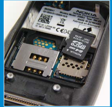
Vízálló burkolat lebont, akksi kivesz, és ta-dam, hozzáférünk a memóriakártyához. Ideje lenne egy vákuumos oldalsót kifejleszteni.
