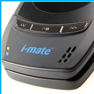
Az itt elhelyezett lejátszásvezérlő-gombok két funkcióval bírnak: rövidebb megnyomás esetén az időt és egyéb állapotjelző ikont jelenítik meg a külső kijelzőn.
