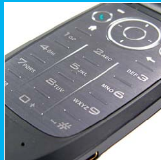
Egyértelműen a Motorola V3-ra hajaz az egyetlen fémlapból előállított, teljesen lapos billentyűzet, amelynek ergonómiaja és minősége is kifogásolható. A fényérő szenzorautomatika állítja.
