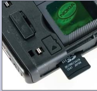
Sajnos még mindig csak hátlaptépkéddel férhetünk hozzá a miniSD-memóriakártyához, amely a mintegy 70 MB-os alapmemóriát hivatott bővíteni.
