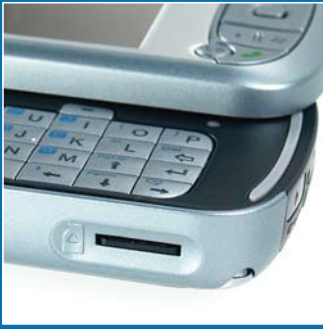
Az alaphelyzetben 64 MB-os memóriakártyát birtokló miniSD-aljzatot sajnos semmilyen borítás vagy fedél nem óvja a külvilág behatásaitól.
