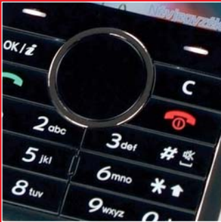
A két funkciógomb érintésérzékeny, viszont a középső navigációs gomb a látszat ellenére nem forgatható.
