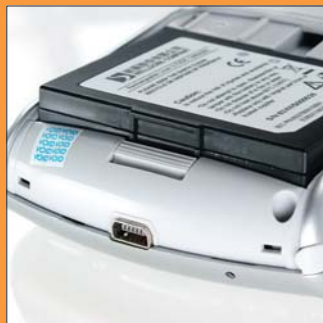
Adatkommunikációs interfészként csak a külső csatlakozású USB-portot találjuk. Ez egyben a töltési feladatokat is ellátja.
