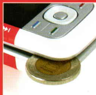
A telefon felső, elcsúsztható része lötyög, és nem illeszkedik pontosan, akár egy 100 forintos is befér a két rész közé.
