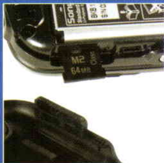
Érdekes megoldás és nem is túl szerencsés, hogy a memcard foglalatát a hátlap védi, nem pedig retesz. Muszáj bontani...
