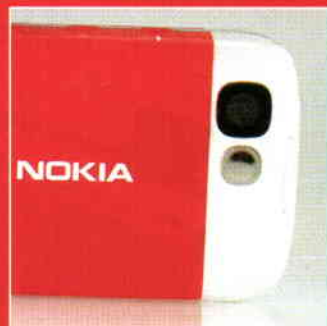
A hátdalapon lapuló beépített kamera 1,3 megapixel felbontású. Mobilfény nincs, van viszont egy apró tükör az önarckép fotózásához.
