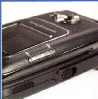
Mindkét oldalon gyorsgombok sorakoznak a lejátszó vezérléséhez. Ezen az oldalon látható még a rugós billentyűzár és az infraport.
