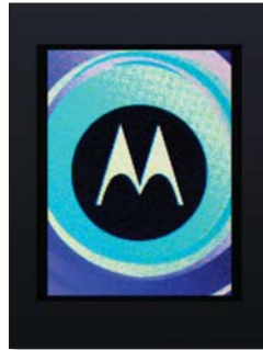
A V6 maxx tükröszerű fedlapja mögött bújkol meg a nagy felbontású (120x160 képpontos) külső kijelző.
