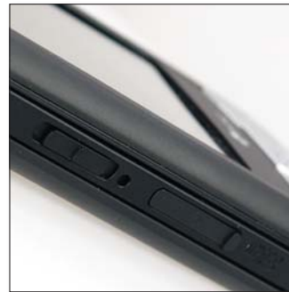
Egy kissé érthetetlen megoldás. Ha kivesszük az akksit, és eltoljuk 2 millit a rezeszt, szabadabbá válik a SIM-kártya.
