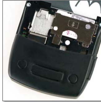
A készülék 50 MB-os memóriája microSD-kártyával bővíthető. A kártyahely az akkufedél alatt található.
