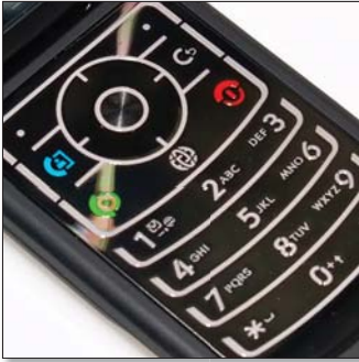
A V6 maxx a pengecsálásban megszokott stílusú billentyűzetet kapta, a gombok egy síkban vannak.
