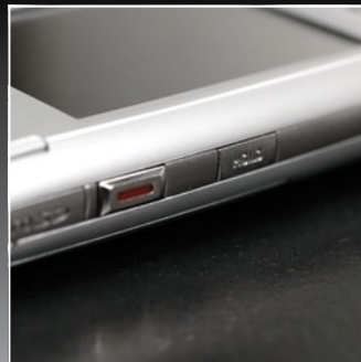
A kamera indító és exponáló gyorsgombja. A fektetett kijelző mellett könnyen és kényelmesen használható.
