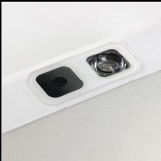
A hátlapra került a 3 megapixeles, autofókuszos kamera. Az optika mellett mobilfény található.
