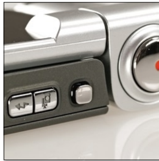
A miniatűr joystick mellett van a fényképezőgép-/kamdorder-üzemmód váltógombja, illetve a vaku bekapcsoló billentyűje. Az N93i sötétben akár elemlámpaként is funkcionálhat.
