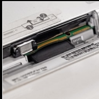
A brutális kapacitású (2200 mAh) akkumulátor alatti nyílásba helyezhetjük be miniSD-kártyánkat.
