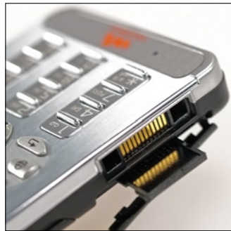
Az M2-memóriakártyákat fogadó bővítőslotot elegánsan gumifül alá bújtatták a tervezők, ellenben a közvetlen közelében található rendszercsatlakozó pórrén maradt.
