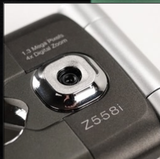
Elöl domborodik az 1,3 Mpixel, amely természetesen videó rögzítésére is alkalmas, csak gyengébb felbontásban.
