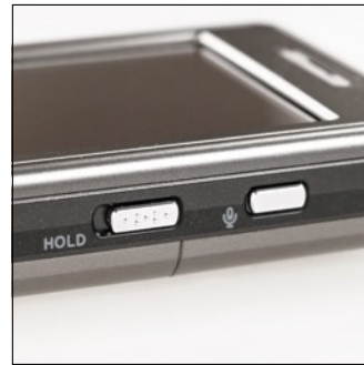
A HOLD csúszkagombbal természetesen nem a Holdra szállás indítható el, hanem egy egyszerű mozdulattal mind a kezelőszervek, mind pedig az érintőkijelző zárható.
