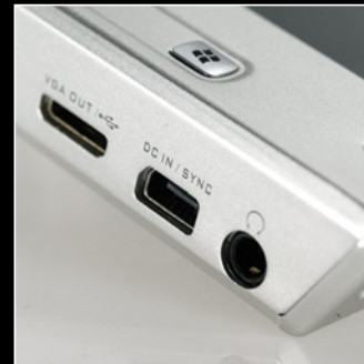
Egymás mellett sorakozik a tv-kimenet, a miniUSB-aljzat, valamint a fülhallgató csatlakozója.
