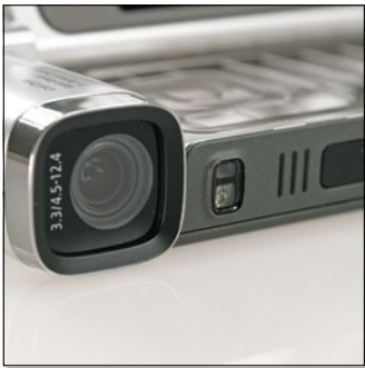
Az objektív alatt nem xenon, hanem normál LED-alapú segédfényt figyel, és erre felé keresendő a jó öreg infravörös port, a POP-port és az akkumulátortöltő mini csatlakozója.
