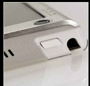
A készülék jobb oldalsó élén lévő külön gombbal indítható a kamerafunkció. Ugyanezzel a gombbal történik az exponálás.
