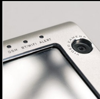
A kijelző jobb felső sarka mellé helyezték el a videotelefonáláshoz szükséges második kamerát.
