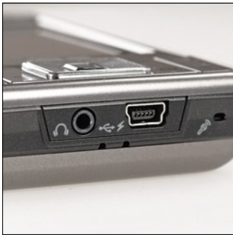
Legalul keresendők a különböző csatlakozóaljzatok: pozitívum a szabványos miniUSB-interfész, de a 2,5 milliméteres audiocsatlakozó helyett igazán használhatók volna szabványos 3,5 milliméterest is.
