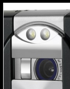
A sötétségre megkettőzött fényerővel támadó LED-segédfényt nemcsak fotózás-kor jön jól, hiszen segítségével elemlámpaként, illetve S.O.S.-jelző készülékként is használható a K550i.
