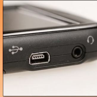
A készülék miniUSB-portja a jobb oldalon található a headset csatlakozója mellett. A számítógéppel való szinkronizációhoz mindössze a Microsoft ActiveSync szoftverre lesz szükségünk.
