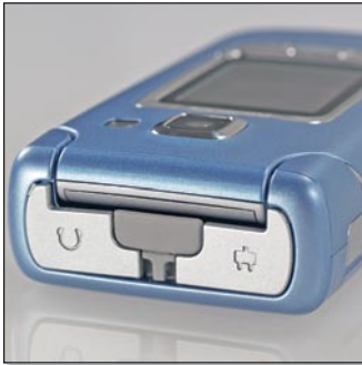
A felső élre került egyrészt a 2,5 milliméteres audiocsatlakozó, másrészt az akkumulátor csatija – mindkettőt diszkrét kis fedlap takarja, amelyek lehajtásába viszont akár a körmünk is beletörhet.
