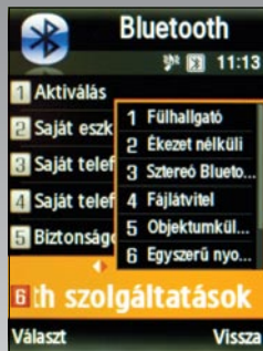
Természetesen az új készülék a sztereó zenehallgatást immár bluetooth-os kapcsolaton keresztül is lehetővé teszi (A2DP).
