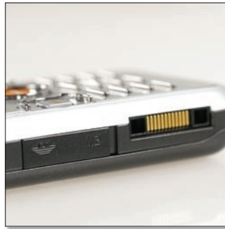
A töltő a vállalat legújabb belső trendjének megfelelően ismét oldalra került – közvetlenül az M2-kártyafoglalat mellé.
