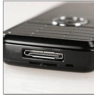
Mindenféle védelem nélkül találjuk a készülék alján a rendszersatlakozót. Kissé puritán megoldás.
