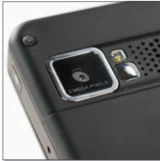
2 megapixel kamera került a hátlapra. 320x240 képpont felbontású videókat lehet vele rögzíteni.
