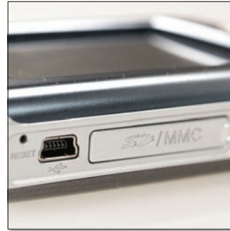
A miniUSB-csatlakozó mellett normál méretű SD/MMC-kártyák fogadására alkalmas kártyaolvasó kapott helyet.
