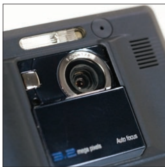
Az objektívet nagyon szerencsésen és szépen kivitelezve védi a Cyber-shotokró jól ismert tolokás retesz.
