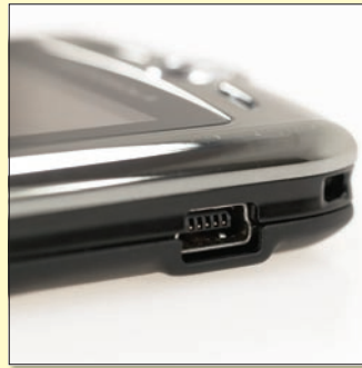
MiniUSB-kábelen keresztül külső meghajtóként vagy akár modemként is működik.
