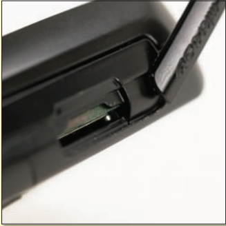
Szinte hasonlóan a korábbi Samsung modellekhez, a memóriakártyát oldalt tehetjük be, és reteszes lapka védi.
