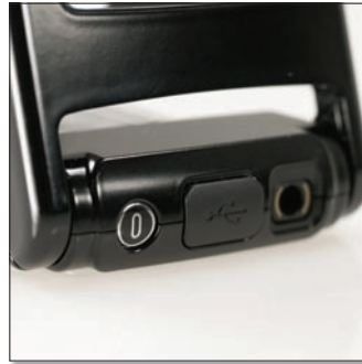
A ki/be kapcsoló gomb és a fejhallgató-csatlakozó között, műanyag védőlap alatt miniUSB-csatlakozó lapul.
