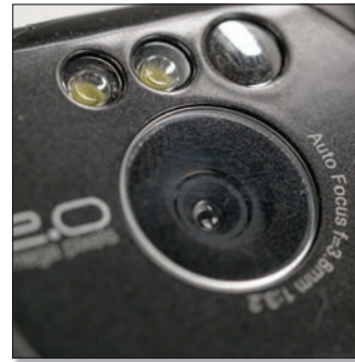
A kétmegás objektív éjszakai használatát nem is egy, hanem rögtön két mobilfényforrás is segíti.
