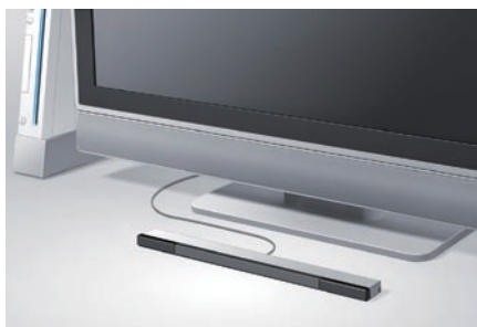
A távvezérlő mozgását érzékelő szenzor nagyjából harminc centi hosszú rúd, és az a dolga, hogy „meghatarozza”, miképpen hadonásszunk a vezérlővel.
