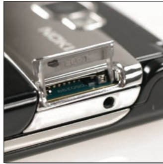
A microSD-kártyafoglat fedele nem kelt túl stabil hatást.
