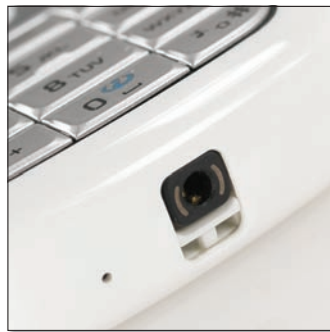
A telefon alján nem 3,5, hanem 2,5 milliméteres audiocsatlakozó lakozik, de a gyári csomagban kapunk egy távirányítós headsetet, amelyre bármilyen 3,5 milliméteres füles rádugható.
