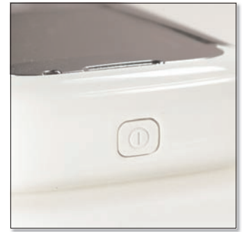
Szokott helyén, a felső élen keresendő a bekapcsoló gomb, amely a telefon életre keltésén kívül a billentyűzár aktiválására és profilváltásra is alkalmas.
