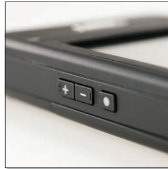
A ponttal jelölt gombbal indítható a hangvezérlő alkalmazás, amely jól működik, de csak angolul ért.
