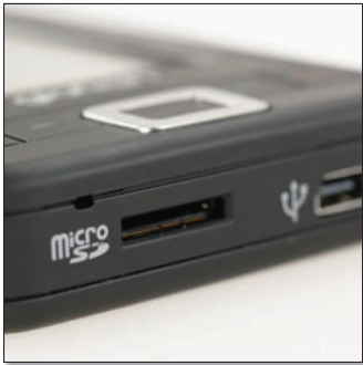
A készülék memóriája microSD-kártyával bővíthető. A kártyanyílás a telefon alján kapott helyet.
