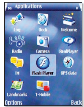
Érdekes: az N76 beépített GPS-antennát nem tartalmaz, „GPS adatok” és „Iránypontok” menüpontot viszont igen.
