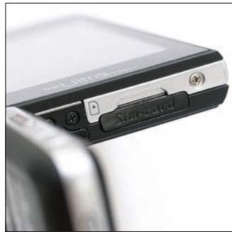
Eltarthat egy darabig, amíg első alkalommal rájövünk arra, hogy hova is kell bedugni a SIM-kártyát: a SIM-slot elővárosolásához csupán annyit kell tenni, hogy szétforgatjuk a készüléket.
