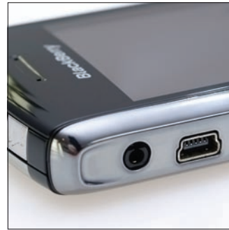
A miniUSB-csatlakozó és a 2,5 milliméteres headsetaljzat fedetlenül figyel ránk a bal élről, a lentebb található, programozható gomb pedig alaphelyzetben a hanghívási funkciót élesíti fel.
