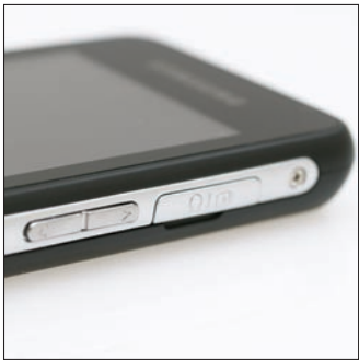
Diszkrét kis műanyag fül alá került az akkumulátortöltő és a headset csatlakozója, ezen kívül pedig fontos, hogy az F500-on egy PAL/NTSC-szabványú tv-kimenetet is találunk.
