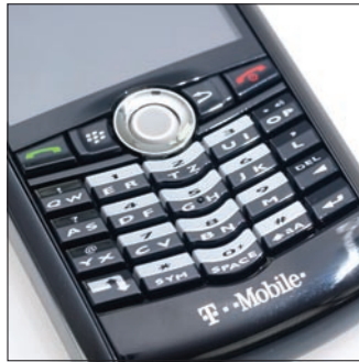
A készülék – üzleti telefonhoz méltóan – teljes QWERTY billentyűzetet kapott, de a tervezők trükkösen osztották ki a karaktereket: egy gombon két betű osztozkodik.
