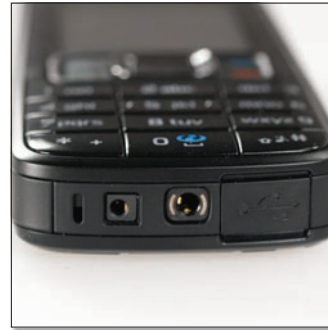
A készülék alján nincs hiány bemenetéből: a miniUSB, a fülhallgató és a töltő is ide csatlakoztatható.
