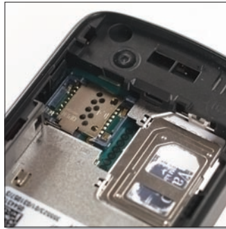
A microSD slotja a SIM mellett kapott helyet, és sajnos csak az akksi kivétele után válik hozzáférhetővé, használat közben nem.
