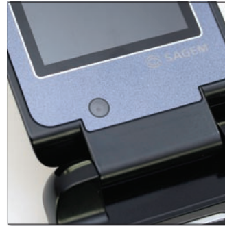
A kijelző alatt találjuk a VGA-felbontásra képes, videotelefonáláshoz szükséges másodkamerát.
