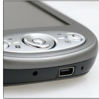
Az alsó szekcióban a jól elrejtett resetgomb társaságában lelhetünk rá a miniUSB-csatlakozóra, ahova nemcsak a töltőt és az USB-kábelt, hanem a gyári vezetékes sztereó headsetet is rádughatjuk.
