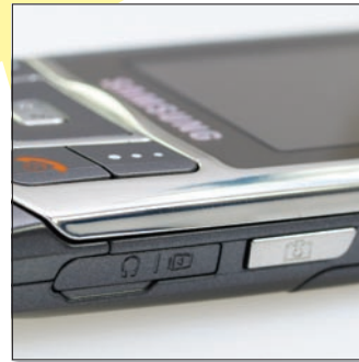
A készülék jobb oldalán kapott helyet a kamera krómszínű gyorsgombja, valamint a füles és a töltő bemenete.
