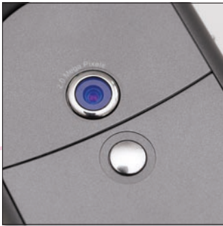
A kamera és a tükör két szerkezeti elem helyett. A kettő közti távolság máris érezteti: a makrofotózás aligha lehet a készülék erőssége.
