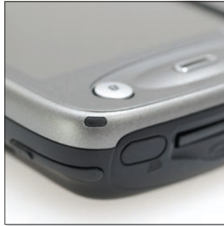
A felső él két szélén egy-egy LED-jelzőfény teljesít szolgálatot, amelyek könnyen emészthető vizuális információt nyújtanak az új üzenetekről, illetve a bluetooth és a WiFi státuszáról.
