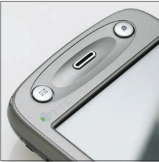
A kijelző felett két kör alakú gombot találunk, amelyek alaphelyzetben a levelezést és a webböngészőt indítják el, de gyakorlatilag bármilyen alkalmazást be lehet rájuk programozni.
