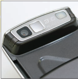
A 3 megapixeles kamera négyszeres digitális zoommal és vakufénnyel is fel van szerelve.
