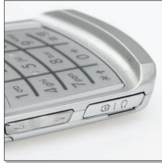
A parányi headset-/töltőnyílás könnyen összekeverhető a túlóldalon levő memóriafoglalat nyílásával, amelyet szintén rezesz véd.
