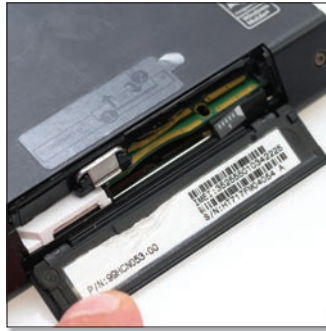
Minden egy helyen: az akkumulátor, a SIM-kártya és a microSD-memóriakártya ugyanazon nyílás alatt található.
