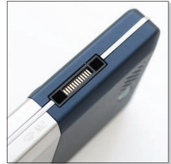
A töltő-, valamint egyben adatportot a készülék oldalán találjuk, amelyek oka abban gyökerezhet, hogy a gyári csomagban található összeépítő, asztali dokkoló oldalról csatlakozik a készülékbe.
