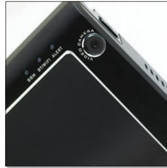
Az előlapi, VGA-felbontású, másodlagos kamera természetesen a videóhívások lebonyolításához szükséges leginkább.
