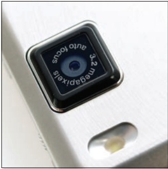
A négyzetes formájú optikát sajnos nem védi elhúzható fedlap, sőt kitüremkedő mivolta miatt egyenesen predestinálva van arra, hogy idő előtt összeszedjen néhány durva karcolást.
