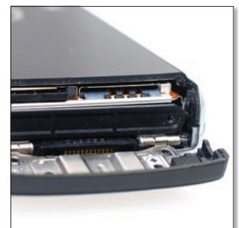
All in: igazi fényképezőgépes megoldás, hogy a SIM-et és a memóriakártyát, illetve az akkumulátort is egyetlen alsó nyíláson keresztül mozgathatjuk!
