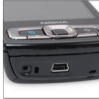
Alul kapott helyet a mini akkuszöltő-csatlakozó, illetve a továbbra is miniUSB-szabványú rendszericsati, valamint ugyanitt van elrejtve a GPS-vevő, amelynek használatához ajánlott szétcsúsztatni az N95-öt.
