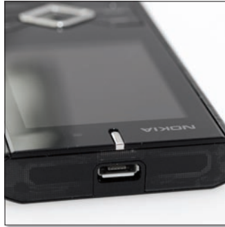
A telefonon mindössze egyetlen csatlakozót találhatunk, amely nem más, mint a színes LED-fények által körbe vett microUSB-aljzat, amely töltésre és adatátvitelre egyaránt használható.
