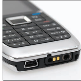
Érdekes módon itt sem microUSB-csatlakozó köszön vissza, pedig 1-2 hónapja még azt hittük, hogy a finnek végleg leszámoltak a miniUSB-vel.
