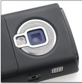
A kamera remek sorozatfelvételi adottságokkal rendelkezik: a fényképezőgép teljes felbontású, vagyis 5 megapixeles fényképeket lő sorozatban, körülbelül másodpercenként egyet.
