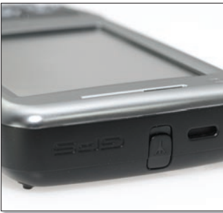
A GPS-vevőt sikerült teljesen elrejtetni, meglátásra mindössze egy GPS-felirat utal, amely mellett egy, a külső GPS-antenna csatlakoztatására szolgáló csatlakozójzat rejlik – szépen egy kis kihajtható fül alá dugva.
