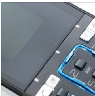
Első pillantásra nem látszik, de számos „rejtőzködő” gomb került a kezelőszervek közé: a kék gombkeret a navigáló, az apró fehér pontok pedig nyomógombok.
