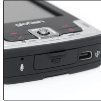
A készülék alján kapott helyet a microSD-kártya slotja, amelyből kialakítása miatt egy kicsit nehéz a kártyákat kihámozni.
