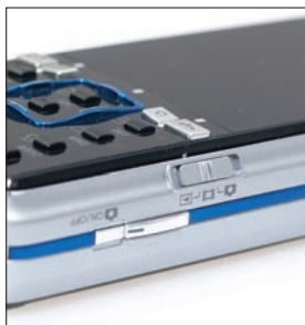
Mint a „nagyok”: kettős nyomáspontú exponáló és háromállású funkciógomb, amely állókép-, video- és lejátszómódban állhat.
