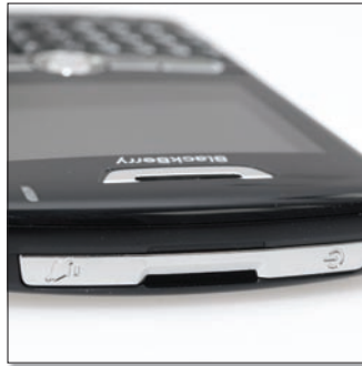
A készülék tetején a jól elkülöníthető bekapcsoló gomb mellett egy másik gombot is találunk, amely a telefon némítására szolgál.
