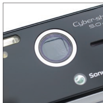
Eltűnt (sajnos) a jól bevált elcsúszó objektívvédő – vagyis egy üveglapon belülré került, és így értelmét is veszítette, hiszen ez az üveglap koszolódik, karcolódik.
