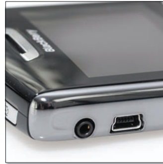
A miniUSB-csatlakozóval könnyen tölthetjük az eszközt bármilyen notebookról vagy számítógépről, ráadásul adatátvitelre is használható.
