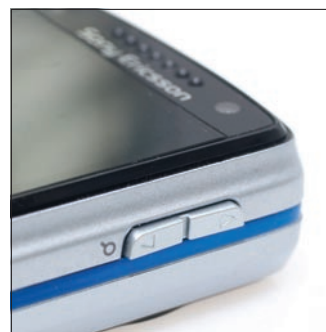
A jól bevált zoomgomb a helyén maradt, és természetesen a telefonfunkció használatakor szokásos hangerő-szabályozó szerepe is megmaradt a készüléken.
