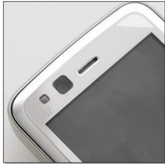
A kijelző felett, a fény szenzor és a hangszóró között található a videohívásokhoz szánt kiegészítő kamera, amelynek felbontása 352x288 képpont.
