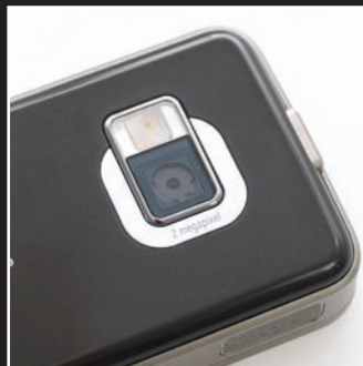
Az N81 nem a fotózás terén nyújtja a maximumot, mivel „csak” 2 megapixeles kamerát integráltak a készülékbe.
