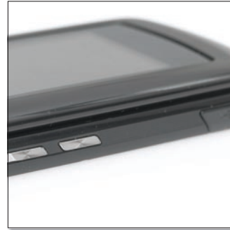
A bal oldali élén a hangerőállító gombok és a fedett microUSB-csatlakozó között kapott helyet az úgynevezett „smart” gomb, amelynek funkciója az adott helyzettől függően mindig más lehet.
