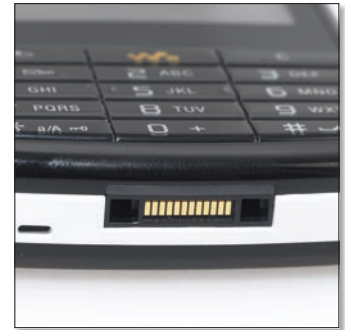
A fastport szabványú rendszercsatlakozó feletti hosszúkás LED-fény az akkumulátor töltöttségi szintjéről, illetve az elmulasztott hívásokról és új üzenetekről nyújt vizuális információt.
