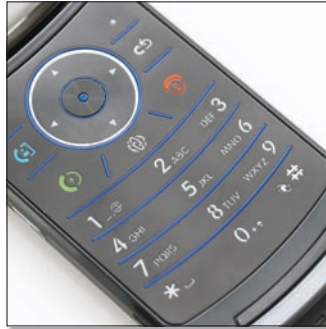
A beépített fényérzékelővel ellátott, két színű gumicsíkokkal tagolt billentyűzet egyetlen gombbal rendelkezik többel, mint a V8 – a háttérvilágítás fehér színű.
