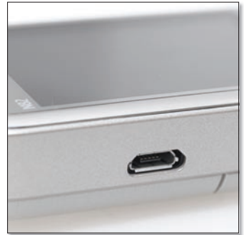
Apró negatívum, hogy a bal oldalon elhelyezett és a legújabb trendnek megfelelően tovább miniaturizált USB-csatlakozó nem kapott kis fedelet, így alaphelyzetben leginkább porfogóként funkcionál.
