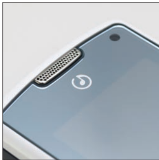
Inaktív állapotban a kijelző a tükörszerű borítás alatt szinte nem is látszik. Felő részén található a hangszóró, az apró hangjegyekon és a videotelefonáláshoz elengedhetetlen kamera lenszéje.
