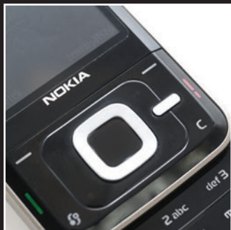
Egyes alkalmazásokban az ujjunk gyűrűn történő körkörös mozdításával is vezérelhető a naviggyűrű.
