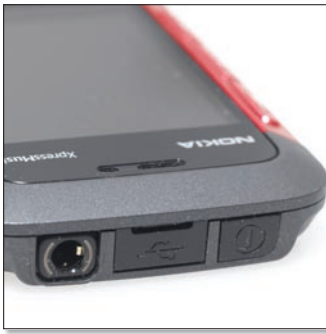
A gyártó egyik leghasznosabb újítása, hogy a fülhallgató bemenete rendhagyó módon a készülék tetején kapott helyet. A használat így akkor is kényelmes, ha a mobil éppen a zsebünkben pihen.
