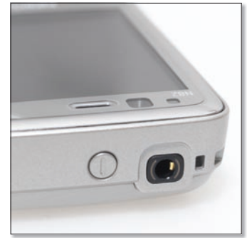
A Nokia N-sorozatú új telefonjain a Sony Ericsson Walkman készülékeiktől eltérően nem egyedi, hanem szabványos 3,5 milliméteres audiocsati van – értelemszerűen ez utóbbi a jobb megoldás.
