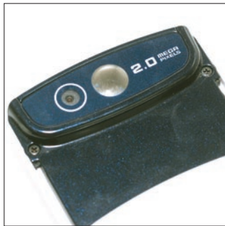
2 megapixeles kamerájával 1600x1200-as fotók készíthetők. Emellett videofelvétel készítésére is van lehetőség 176x144 pixeles felbontásban.
