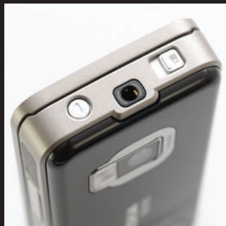
A készülék felső részén található a billentyűzár csúszkája, mellette pedig a 3,5 mm-es fülhallgató-csatlakozó.
