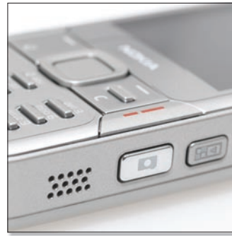
A tizennégy parányi lyuk alá rejtett hangszórók a jobb oldali él alsó és felső részére kerültek, és a hangerő/zoom gombjait, valamint az exponáló és a gáléria billentyűit fogják közre.
