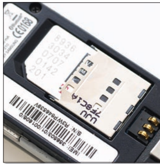
A készüléktest meglepő méreteit mi sem mutatja jobban, minthogy a SIM-kártyafoglalat majdnem a teljes szélességet befoglalja.
