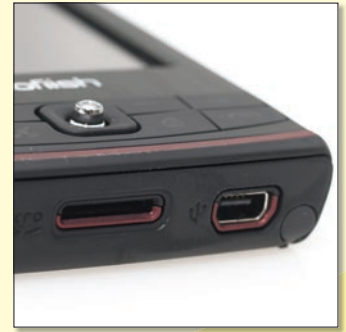
A microSD-foglalat és a miniUSB-csatlakozó – borítás hiányában – gyorsan koszolódik.
