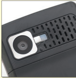
A krómkeretbe foglalt, 2 megapixeles, fixfókuszos kamera elég lassan dolgozik.
