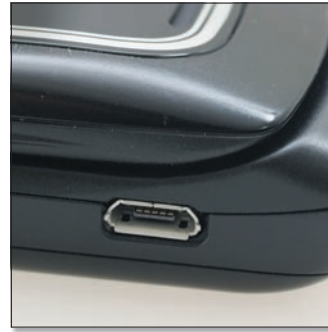
Jól láthatóan már ez a telefon is a vékonyabb microUSB-csatlakozóval készült.
