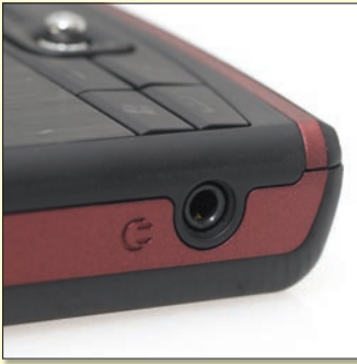
A 2,5-es fejhallgató-csatlakozó alkalmazása a 3,5-esnél rosszabb, az USB-s változtnál viszont jobb választás.
