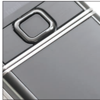
Közvetlenül a kijelző alatt öt kezelőszert helyeztek el: ahogy az ötlállású navigációs gomb, úgy a mellette elhelyezett és alap helyzetben kivilágítatlan gombok sem érintésérzékelnyek.
