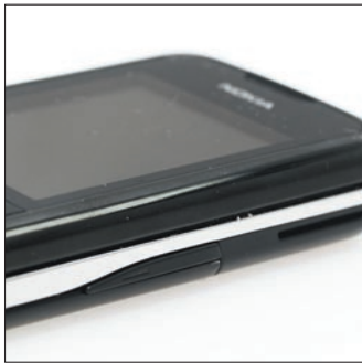
A vastag ezüst csikkal díszített oldalsó élék bizony nem sok funkcionalitást hozhatnak: a rajtuk elhelyezett mindössze két gomb csak a fém hátlap leoldását hívatott elősegíteni.
