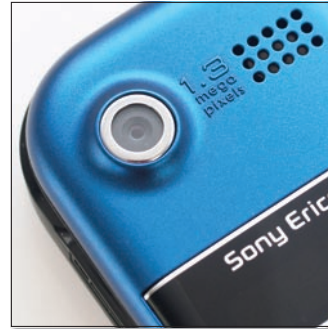
A beépített kamera 1,3 megapixeles és maximálisan 1280x1024 pixeles felbontású képek rögzítésére képes, de a mobilfény hiánya miatt igazából csak nappal használható.
