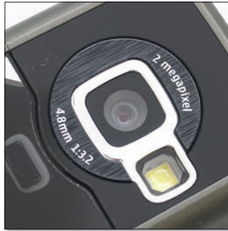
Fotózás terén nem estek túlzásba a tervezők: egy teljesen átlagos, 2 megapixeles, autofókusz nélküli kamera került a hátlapra.
