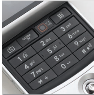
A billentyűzet és a gyorsgombok, valamint a videóhívás kamerája csak akkor kerülnek elő, ha a képernyőt elfordítjuk.
