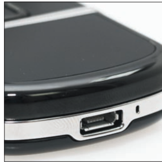
Az alsó élen található rendszercsatlakozót illetet volna némi borítás alá rejteni, mindenesetre jó hír, hogy a szabványos microUSB-s interfész adatátvitelre és akkumulátorra egyaránt alkalmas.
