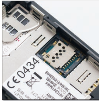
Sajnos a design miatt az akkumulátor alá száműzték a microSD-foglatot.
