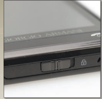
Senkit se tévesszen meg az alsó kis-lakatjelzés, ugyanis az itt látható gombbal nem a billentyűzetet, hanem a hátlapot lehet reteszelni!
