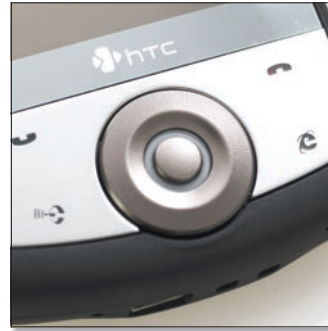
A HTC ezúttal egy különleges navigációs gombnak szavazott bizalmat: ez a készülék bizony nem egyszerűen csak nyomogatható (öt irányban), hanem felülete forgótárcsaként is használható.
