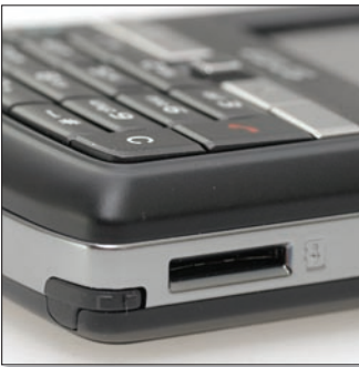
A kamera exponáló gombja mellé bigy-gyesztett, SDHC-kompatibilis (maximum 8 GB microSD) bővítőslot egy kicsit elnagyolt kivitelű, hiszen elfelejtették elrejtetni a szemünk előtt.
