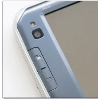
Az előlapon elhelyezett kamera nem fotózásra való: csupán VGA-felbontású, és videotelefonáláshoz került az N810-esbe.
