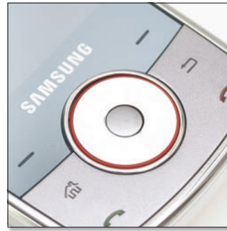
A tekerőgomb segítségével gyorsan navigálhatunk a menüpontok között. Használatkor sok probléma volt viszont a mellette levő érintésérzékeny gombokkal.
