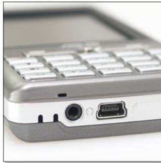
A miniUSB- és a fejhallgató-csatlakozó a készülék alsó részére került. Kár, hogy utóbbi a kevésbé elterjedt „kettős felés” változat.
