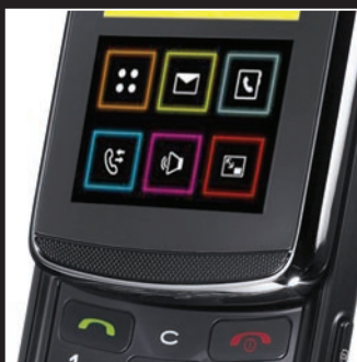
A numerikus billentyűzeten nincs navigációs billentyű, a kezelést teljes mértékben az interaktív kezelőpanel látja el.
