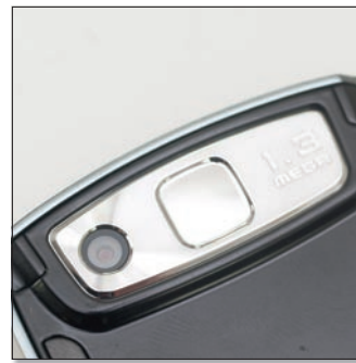
Sorozatfelvevő módban 6, 9, illetve 15 fotó készül gyors egymásutánban, de sajnos csak QVGA-felbontásban, ha pedig videómódra váltunk, be kell érünk a 176x144 pixeles maximális felbontással.
