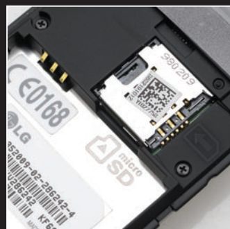
A készülék belső memóriája microSD-memóriakártyával bővíthető. A kártyát az akkumulátor alatt található részbe kell betolni.
