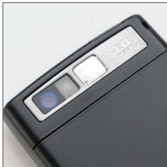
A beépített kamerához sajnos túl közel került a mobilfény, így inkább használhatjuk sötétben kulcslyukkeresésre, mint éjszakai képek készítésére.
