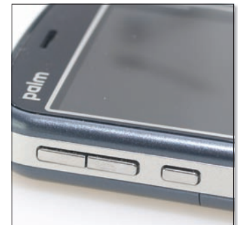
Baloldalt kapott helyet a hangerőállító gombpár, amely kezelőszervek az úgynevezett „Side Button” társaságát élvezik – ez utóbbi nyomva tartásával azonnal életre kelthető az internetböngésző.
