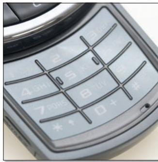
A szétcsúsztatást követően felbukkanó normál billentyűzet jól etalált méretű gombjainak felületén körkörös recézést fedezhetünk fel, így ujjaink garantáltan nem fognak elcsúszni gépelés közben.
