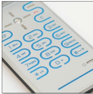
A Motorola-féle RAZR billentyűzet-megoldás a jelek szerint immár a Sony Ericsson is megihlette: az egyetlen perforált lapból készült billentyűzet gombjait vékony gumicsíkok határolják.
