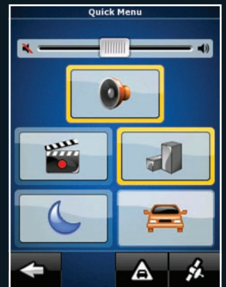
A gyorsmenü segítségével anélkül változtathatjuk meg az alapvető beállításokat (hangerő, éjszaka/nap, jármű), hogy elvesznénk a funkciók és szolgáltatások egyre sűrűbb erdejében.
