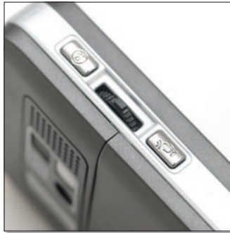
Bal oldalon egy „jog dial” gomb található, amely csak háromállású. Ezzel tudunk a menüben lépkedni vagy a hangerőt szabályozni.
