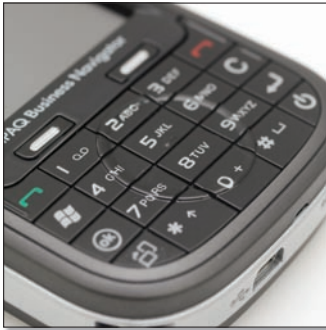
A billentyűzetben van egy kör alakú ki-domborodás, amely nem designelem. A kerek domborulat a navigációs gombot jelzi.
