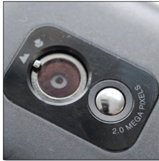
Az objektívgyűrűre helyezett makrofelvétel-kapcsoló nem a legideálisabb megoldás.
