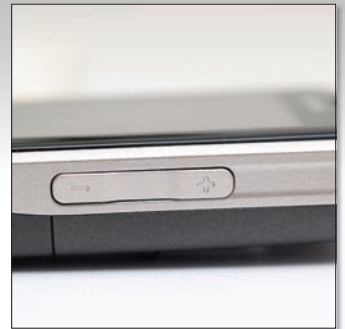
Jobb oldalon keresendő a szokásos + és - gomb, amelyekkel nemcsak a hangerő állítható, hanem fotózás közben ezekkel szabályozható a digitális zoom nagytáji szintje.
