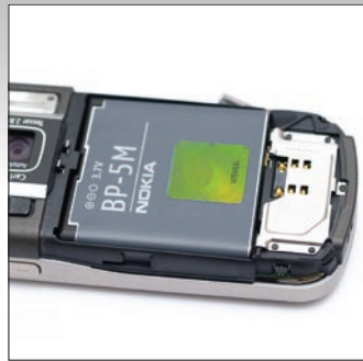
A szokatlanul kemény műanyagból készült hátlap könnyedén leszedhető, alatta pedig egy BP-5M típusjelzésű akkumulátor teljesít szolgálatot a maga 900 mAh-s kapacitásával.
