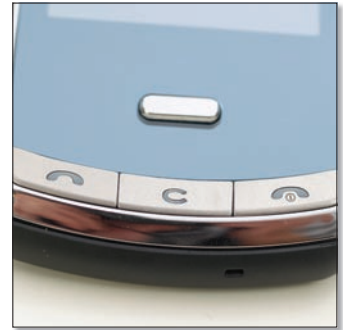
A kijelző alatt található az érintésérzékeny kezelőfelület. A közepén elhelyezett OK gomb hagyományos kivitelű.
