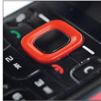
A vaskos vörös peremmel ellátott központi navigációs gomb az N-Gage támogatása miatt egyedi módon nyolcírányú, ez azonban a normál használat mellett sok bosszúságot okoz (pontatlan működéskés).
