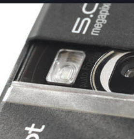
A C902 nem a jól bevált xenon vakut kapta, hanem egy szimpla LED látja el ezt a funkciót.
