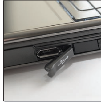
A jelzésből nem nehéz kitalálni, hogy ide került az USB-csatlakozó, méghozzá annak microUSB-verziója.
