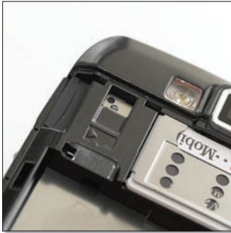
A memóriakártya a hátlap alá került, ami bizony manapság nem tekinthető elegáns megoldásnak.
