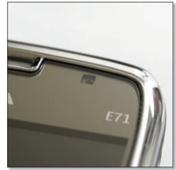
Szinte alig vehető észre a készülék előlapján elhelyezett második számú kamera, amely videotelefonáláshoz való.
