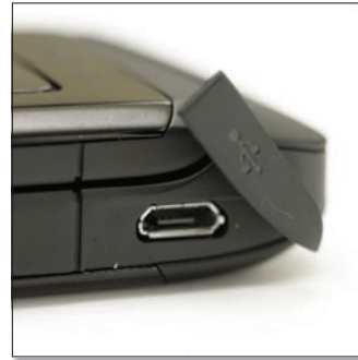
Az USB-csatlakozó a trendeknek megfelelően microUSB, és ezt is egy műanyaglap védi a porosodás ellen.
