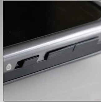
A szokásos hangerőállító gombok mellett a billentyűzár tolókapcsolója található. Egyszerű, de hatásos megoldás.
