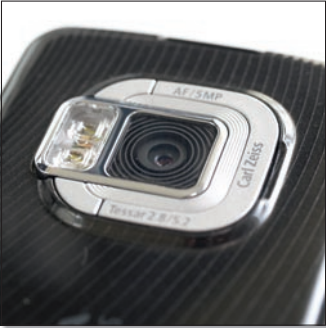
A hátlapon Carl Zeiss Tessar objektívvel ellátott 5 megapixeles kamera pihen. A kamerával VGA-videók készíthetők.
