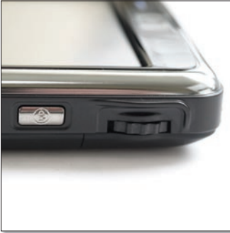
Jobboldalt keresendő a recés felületű jog-dial kezelőszerv, amely nemcsak le és fel tekerhető, hanem természetesen be is nyomható, amely jelentősen megkönnyíti az egykezes használatot.
