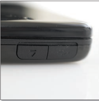
A felső élen elhelyezett microUSB-csatlakozó végre olyan, amilyennek lennie kell: alaphelyzetben rejtett, és töltésre, adatátvitelre, valamint fülhallgató csatlakoztatására egyaránt használható.
