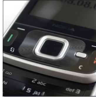
A jól használható navigógomb körül csoportosulnak a főbb kezelőszervek. A navi körül „láthatatlan” zenevezérlő gombok találhatóak.
