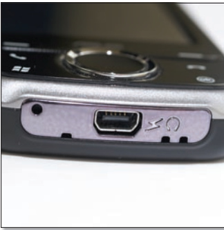
Az alul található miniUSB-csatlakozó töltésre és adatátvitelre szolgál, és ide csatlakozik a gyári headset is.
