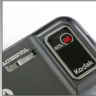
Nagy betűk jelzik, hogy a ZN5 optikáját a Kodak készítette. Jó megoldás, hogy eltolható retesz védi az objektívet.
