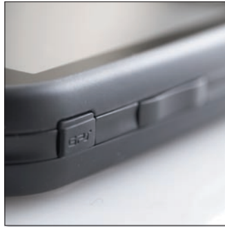
Az ASUS egy kicsit túlbuzgó módon még egy külső GPS-antenna csatlakoztatását is lehetővé tévő csatit is elhelyezett a telefon bal oldalán – a SiRFstarIII chipsetes GPS-vevő külső antenna nélkül is kiváló.
