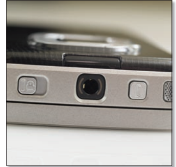
3,5 mm-es csatlakozó várja a fülhallgatót, a mellette található retesz pedig a billentyűzár funkcióját látja el.
