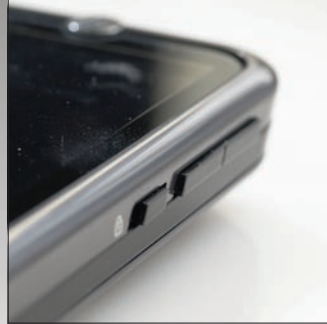
A készülék bal szélső élén, a billentyűzár toldógombja felett a hangerőgombokat helyezték el.
