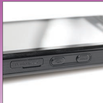
A belső memória bővítéséhez a gyártó 1 GB-os microSD-kártyát ad, a műanyag zárral védett kártyahely a készülék oldalára került.
