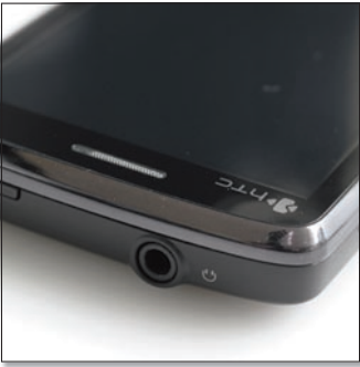
A 3,5-es csatlakozónak köszönhetően kedvenc fülhallgatónkkal is remekül kooperál a Touch HD.
