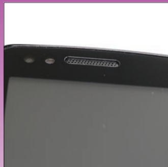
A készülék előlapján, a kijelző felett a telefon hangszóró, a fényérzékelő, valamint a videótelefonáláshoz való kamera található.
