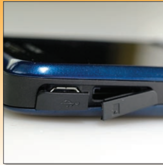
A műanyag zárszerkezetek óvják a csatlakozókat a kosz behatolásától.
