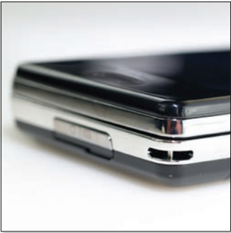
A felső élen keresendő a diszkrét módon elrejtett rendszersatlakozó (töltés, adatátvitel, headset, tv-kimenet), szabványos USB- vagy 3,5 milliméteres csati nincs a második Prada mobiltelefonon.
