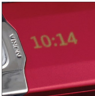
Dupla kijelző: a különleges anyagú burkolat alól átfénylik egy, a flipbe rejtett másodlagos kijelző.
