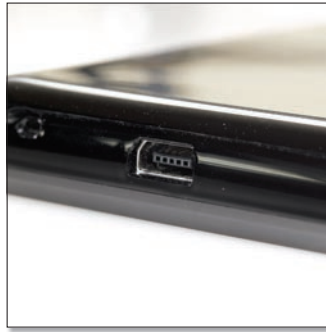
A készülék alján szabványos USB-csatlakozó található, a készüléket USB-n keresztül számítógépről is tölthetjük.
