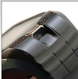
Az óramobil felső részében elhelyezett kamera csupán VGA felbontású felvételeket képes készíteni.
