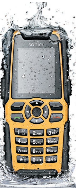
A hátlapot csavarokkal kell rögzíteni. Csak akkor vízhatlan a készülék, ha megfelelően becsavarjuk őket.
