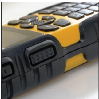
A készülék éleit vastag védőelemek óvják a sérülésektől. Az oldalsó kezelőgombok teljes biztonságban vannak.
