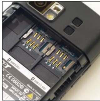
A két SIM kártya közül csak az egyik esetében használható a HSDPA adatátvitel, a másik csak 2G-s szolgáltatásokat nyújt.
