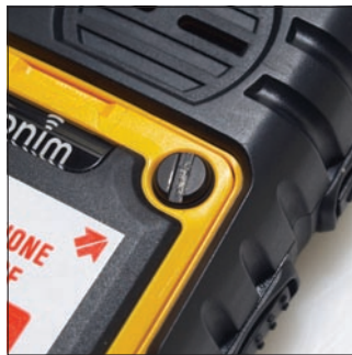
A hátlapot csavarokkal kell rögzíteni. Csak akkor vízhatlan a készülék, ha megfelelően becsavarjuk őket.
