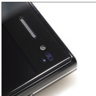
Az előlap sík felületét csak a hangszóró-rács és a második számú, VGA felbontású kamera töri meg.
