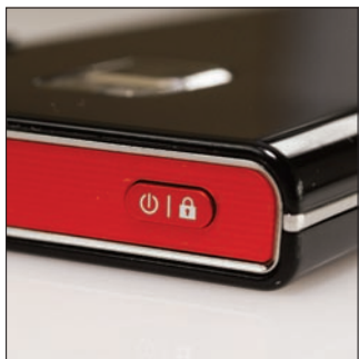
A készülék tetején elhelyezett apró gomb a készülék ki- és bekapcsolására, valamint a zárolására szolgál.
