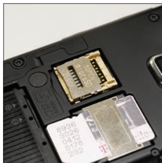
A microSD memóriakártya bővítőhelye a hátlap alá került. Maximum 32GB-tal bővíthető a memória.
