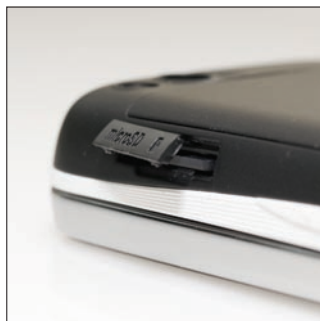
Egy körömmel kipattintható fedél védi a porosodástól a microSD memóriakártyát fogadó bővítőhelyet.
