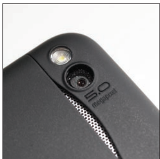
A hátlapra 5 megapixeles autofókuszos kamera került. A fotózást videofényként is használható LED villanó segíti.
