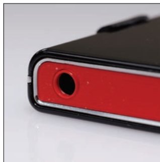
A felső élen található a szabványos fülhallgató csatlakozó, amihez bármilyen 3,5-es fülhallgató csatlakoztatható.
