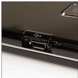
A telefon egyetlen csatlakozóját felhajtható fedlap alá rejtették. Ide csatlakozik a töltő és az adatkábel.
