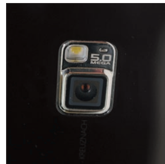
A hátlapon elhelyezett 5 megapixeles, Schneider-Kreuznach optikájú kamera mellé LED fény került.
