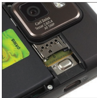
A memória bővítésére szolgáló microSD kártyafoglatat eléréséhez le kell venni a készülék hátlapját.
