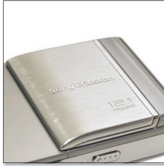
A kamera optikáját a hátlapból kiemelkedő eltolható retesz védi. Amint eltoljuk, a kamera alkalmazás máris életre kel.
