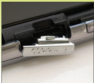
A Touch2 memóriája microSD kártyával bővíthető, a nyílást védő „ajtót” a hátlap levétele után lehet kinyitni.
