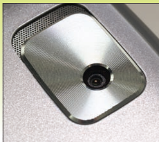
Elég fapados a hátlapba épített 3 megapixeles kamera: nincs vaku, és meg kell elégednünk a fix fókussszal.
