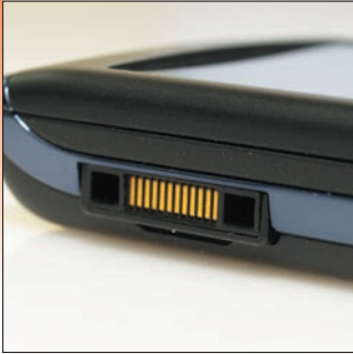
A Sony Ericsson bumszli Fast port csatlakozója került az Aino-ba, de legalább egy mozdulattal a dokkolóba helyezhető a telefon.
