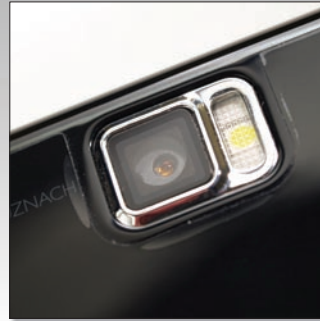
Az 5 megapixeles, Schneider Kreuznach optikájú kamera autofókuszos, és LED fényvel látták el.
