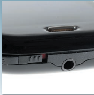
A Palm tervezői szerencsére gondoltak a zenehallgatókra: a készülék tetejére 3,5-es jack audio kimenet került.
