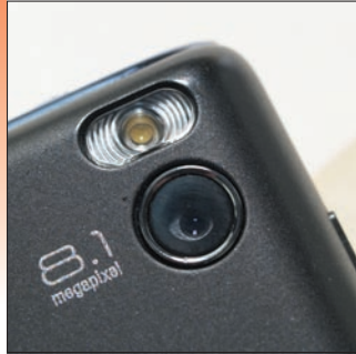
A 8,1 megapixeles, autofókuszos kamera a szokásos LED fényt kapta. Végre nincs gond a videofelvétel felbontásával.
