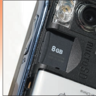
A microSD kártyahely a hátlap alatt található, de a kártya eléréséhez nem kell eltávolítani az akkumulátort.
