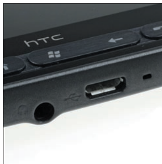
A készülék aljára microUSB-csatlakozó, valamint 3,5 mm-es fülhallgató kimenet és a mikrofon került.
