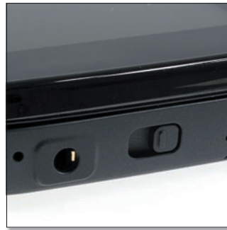
A képernyőzár funkciót betöltő csúszka a készülék aljára került. Emiatt elég nehézkes a telefont egy kézben tartani és eltolni.
