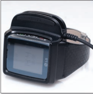
Az egyedi készülékhez egyedi töltő-bőlcső is tartozik, amely az akkumulátor töltése mellett természetesen az USB-s számítógép-csatlakozásért is felelős.
