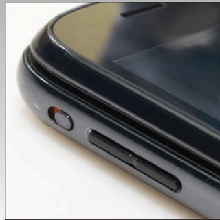
A hangerőállító gombok feletti eltolható gombbal egyetlen mozdulattal néma üzemmódra válthatunk.
