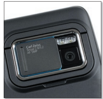
A lencsevédővel ellátott 5 megapixeles kamerával 848x480 képpont felbontású videófelvételeket lehet készíteni.
