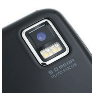
Az 5 megapixeles, autofókuszos, dupla LED fényel felszerelt kamera optikáját nem védi semmi.
