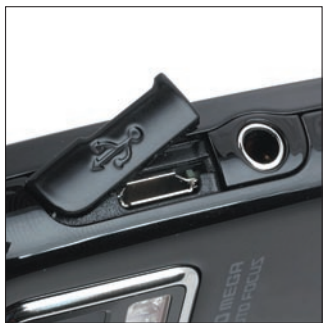
Az Omnia II szabványos csatlakozókat kapott: 3,5-es jack és egy microUSB csatlakozó került a készülék tetejére.
