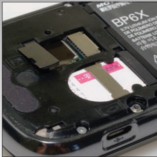
A memóriakártya a SIM kártya mellé, a hátlap alá kerül, de az akkumulátort nem kell eltávolítani.
