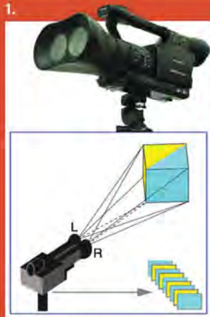
1. A 3D kamera két lencsével és két képérzékelő szenzorral rendelkezik, így két különböző képet rögzít, Full HD felbontásban a jobb és bal szem számára.
