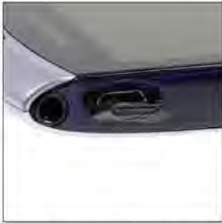
Végre szabványos csatlakozókkal találkozunk: micro-USB és 3,5-es jack csatlakozó került a készülékbe.
