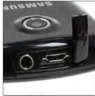
A Monte mikro USB-töltő, illetve adatkábelt csatlakozót, valamint 3,5 jack aljzatot kapott.
