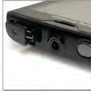
Az X10-es felső élén szabványos csatlakozók trónolnak: a microUSB mellett 3,5-es jack csatlakozó pihen.
