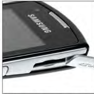
A 200 MB-os belső memória microSD-kártyával bővíthető, a kártyanyílást ki-hajtható műanyag fedél védi.
