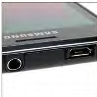
A készülék tetején szabványos csatlakozók sorakoznak. Töltéshez és adatátvitelhez microUSB, zenehallgatáshoz 3,5-es jack aljzat.
