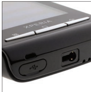
MicroUSB csatlakozó a töltéshez és az adatátvitelhez, 3,5-es jack aljzat a zenehallgatáshoz. Eltűntek az egyedi csatlakozók.
