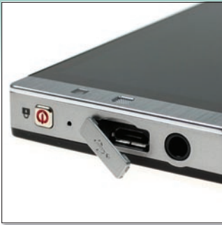
Felül a ki- és bekapcsológomb, a microUSB, valamint a 3,5-es fülhallgató csatlakozója.
