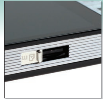
Precíz kivitelű, eltolható „ajtócska” mögé került a microSD memóriakártya foglata.
