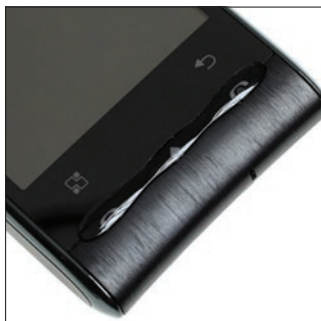
A kijelző alatt lekerekített formavilágú fizikai kezelőgombok sorakoznak, felettük két érintőgomb.
