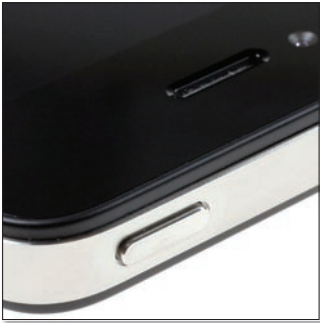
A készüléket életre keltő, a kerethez hasonlóan fémből készült gomb a szokásos helyre, a felső él jobb oldalára került.
