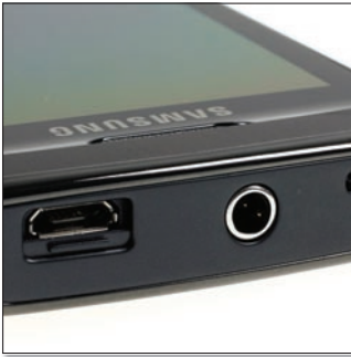
A Wave felső élére helyezték a csatlakozókat: elhúzható fedéllel védett micro USB és 3,5-es jack csatlakozó található itt.
