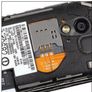
SIM- és memóriakártya helyet találunk, ha levesszük az X10 mini hátlapját, de az akkumulátor nem cserélhető.
