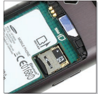
A memóriakártyát az akkumulátor alá kell elhelyezni, ami nem igazán szerencsés, ha gyakran kell kivenni a kártyát.
