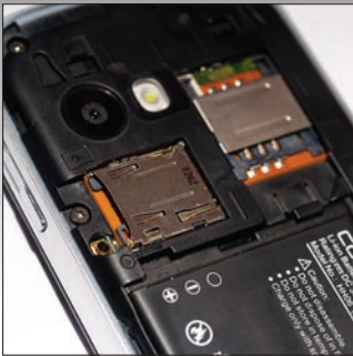
A memóriakártya nyílás a hátlap mögött található, az akkumulátort azonban nem kell eltávolítani.
