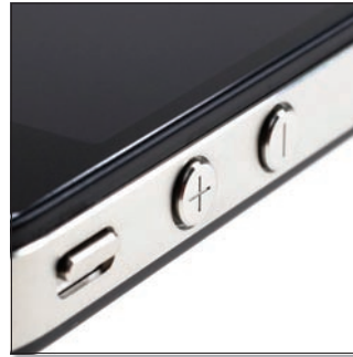
A hangerőállítást két stílusos kialakítású billentyűvel oldotta meg az Apple. A billenőkapcsoló masszívabb, mint az elődökben.
