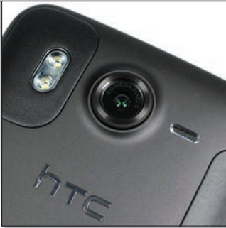
A 8 megapixeles kamerát dupla LED fényvel látták el. Az optikát nem védi semmi, de a hátlap síkja alá kerül.
