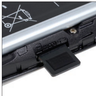
A készülékhez adott 1 GB-os microSD kártyát a hátlap eltávolítása után lehet a helyére beilleszteni.
