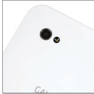
Egy táblagépbe nem feltétlenül kell kamera, a Samsung azért beépített egy 3,2 megapixeleset, LED villanóval.
