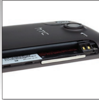
A unibody kialakítás miatt nincs levehető hátlap, az akkumulátort a készülék oldalán található részbe kell becsúsztatni.
