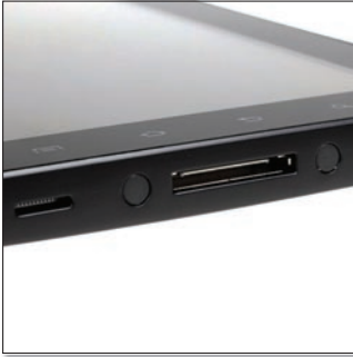
Nem microUSB csatlakozó szolgál a töltésre és adatátvitelre. A 30 tűs csatlakozó hasonló az iPad csatlakozójához.
