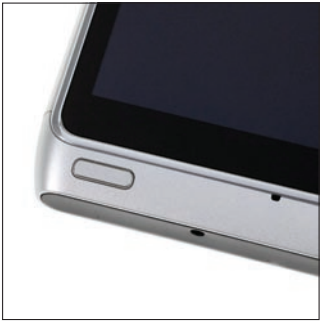
A kijelző alatt mindössze egyetlen gomb található. Hosszan nyomva megjelenik a multitasking felülete.
