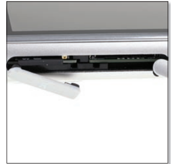
Az akkumulátor beépített, ezért a SIM kártyát a készülék oldalán elhelyezett nyílásba kell csúsztatni.
