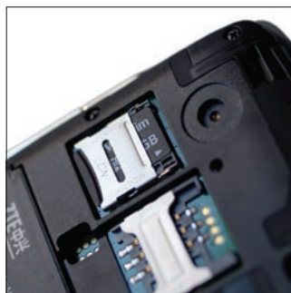
A memóriakártya a viszonylag nehezen lepattintható hátlap mögé került, mellette a SIM kártya foglalatja.
