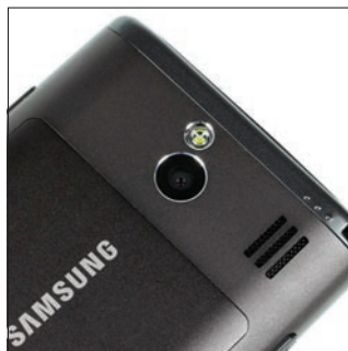
A kamera optikája mellett pihen a LED villanó. Az optikát védő üveg egy síkban van a hátlappal, így könnyen karcolódhat.
