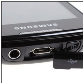
A microUSB aljzatot méretes fedél védi. Mellette a 3,5-es jack aljzat, valamint a be- és kikapcsológomb.
