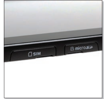
A SIM és a microSD kártya fedéllel védett nyílása egymás mellé került. A Galaxy Tab normál méretű SIM-et fogad.
