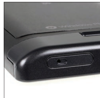
Az készülék alsó fertályán nem valami trükkösen nyíló nyíláshoz férhetünk hozzá, csupán a mikrofon került ide.
